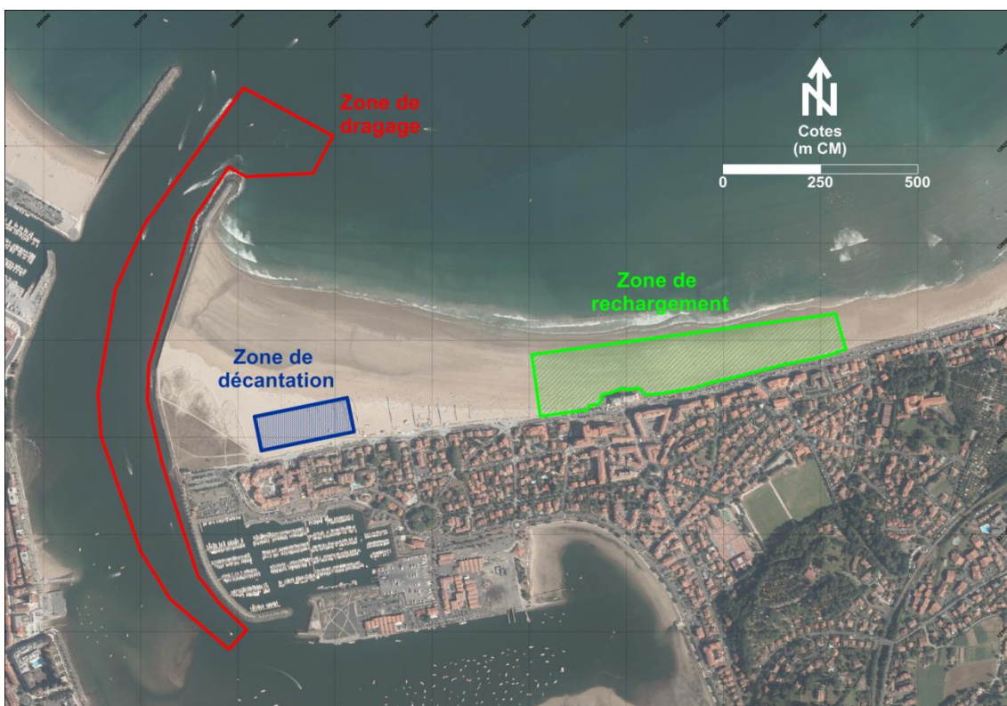
Figure 12: Zone de rechargement dont la plage sèche créée en haut de plage.
