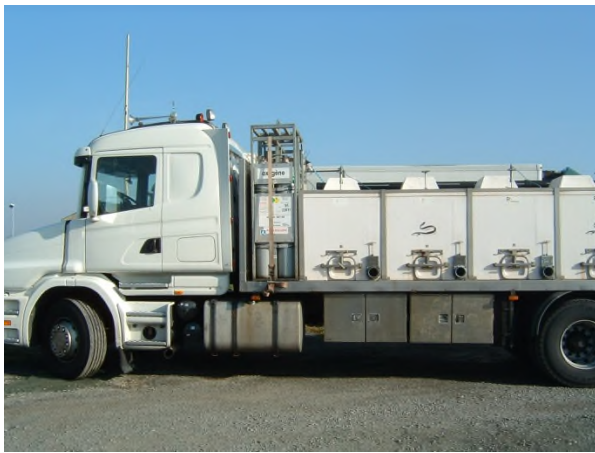
Camion à 6 viviers
