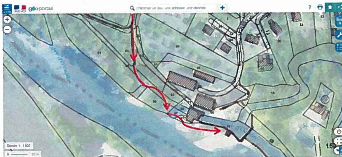
Figure 16 - Accès au chantier pour les travaux en contrebas du canal d'amenée
