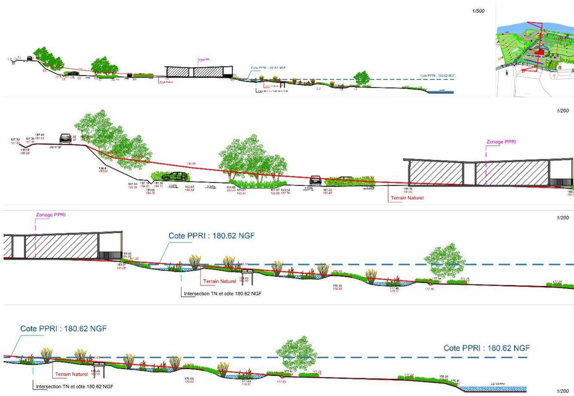
*Profil du projet (en rouge : le terrain naturel, en pointillé bleu : ligne des plus hautes eaux du PPRI et en ligne verticale rouge au niveau du bâtiment : la limite du zonage PPRI)*
