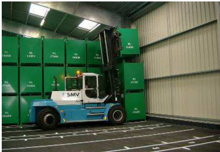
Figure 7 : Gerbage de conteneurs à l'aide d'un chariot élévateur
