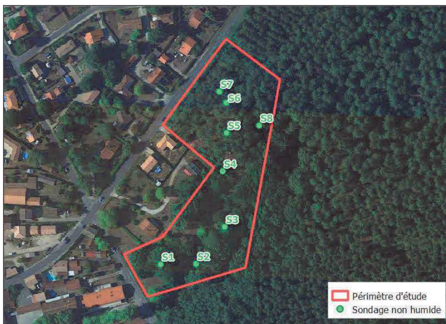
Figure 3 : Implantation des sondages
