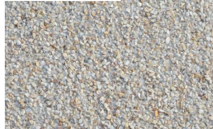
Résine en agrégats de quartz beige 2,5/5 pour la matérialisation de la traversée piétonne et des places PMR
