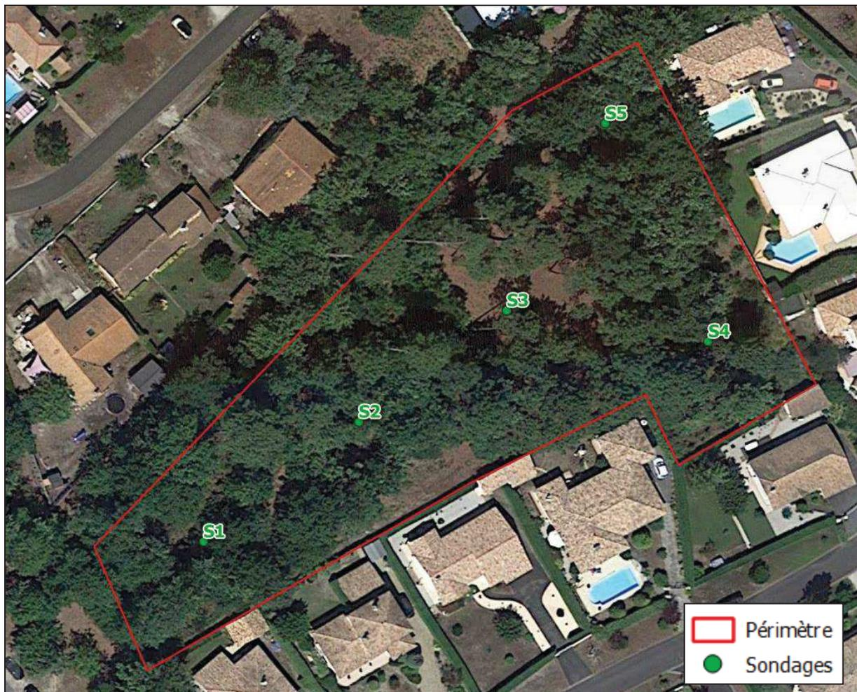
Figure 3 : Implantation des sondages
