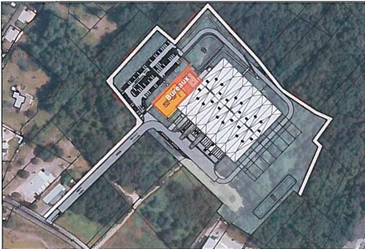
Figure 3 : Seconde esquisse (modification de la localisation des bureaux et de l'accès, réduction de la surface de l'entrepôt)
