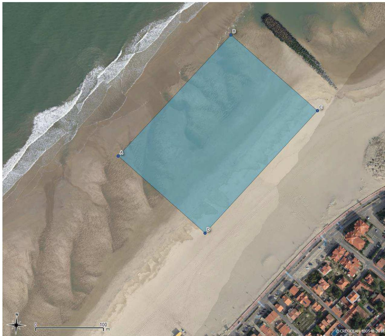
Figure 12 : Zone d'emprunt du sable en amont-dérive de l'épi Barriquand (Orthophotographie ©IGN, Observatoire de la Côte Aquitaine, 2017).
