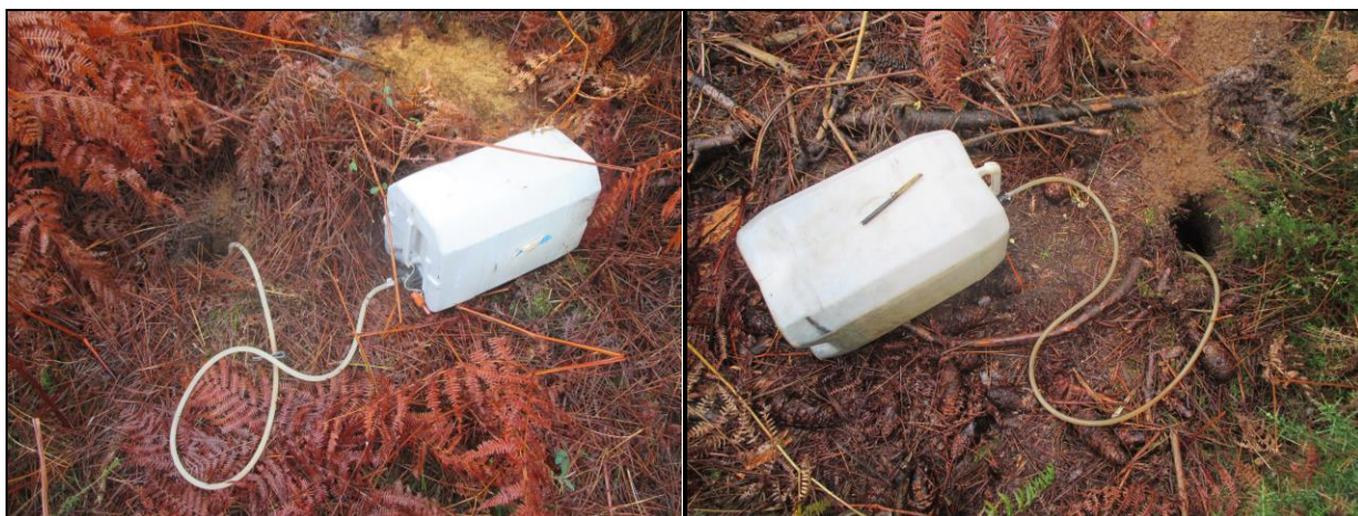
Figure 3 : Tests de perméabilité réalisés sur site
