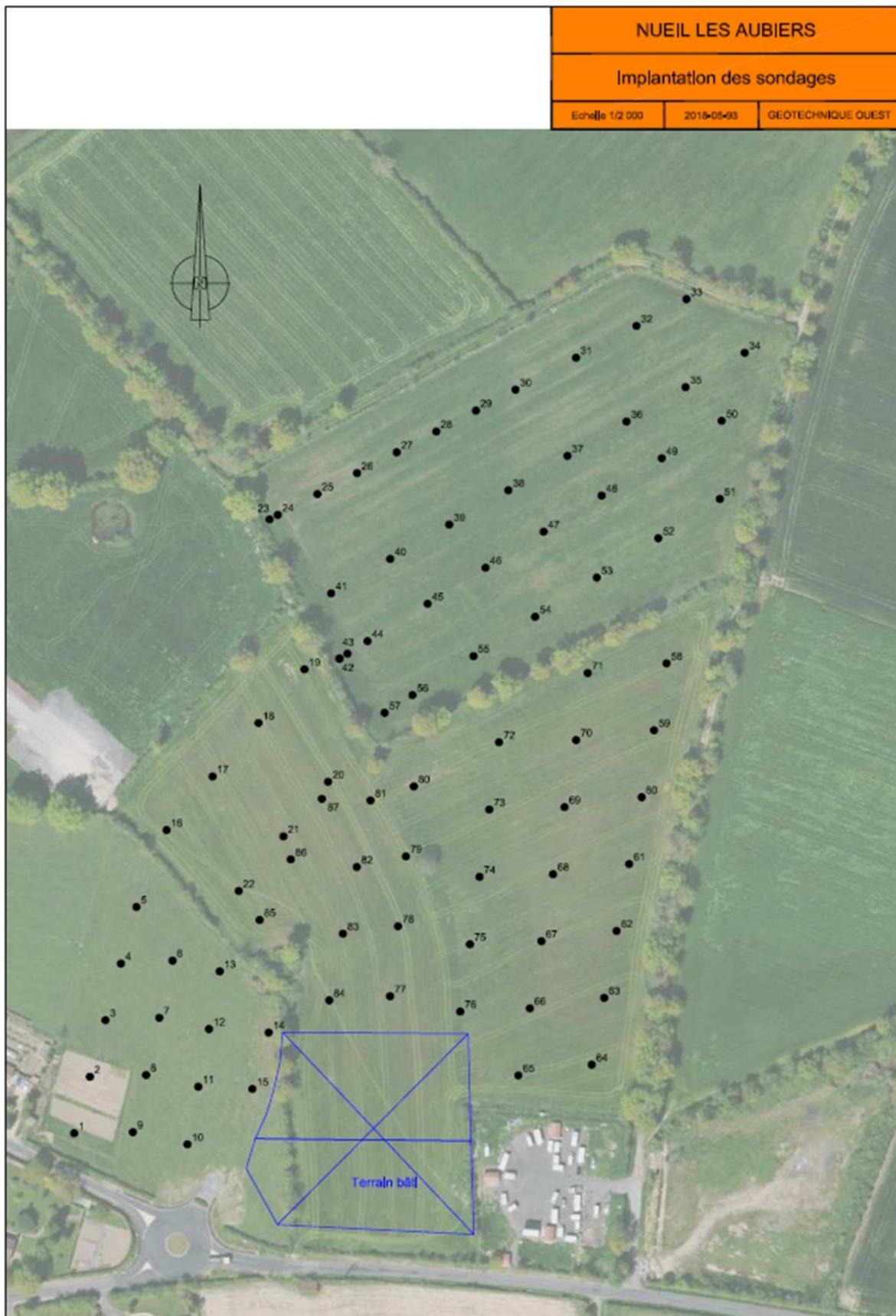
Carte 5 : Implantation des sondages (Source : Etude de zone humide réalisée par Géotechnique Ouest, juillet 2018)
