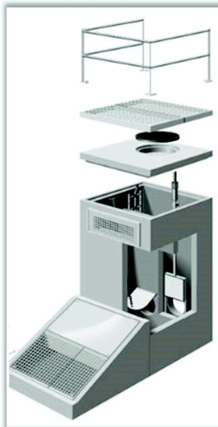
Figure 37 : Schéma de principe de l'ouvrage de régulation – BE Dejante
