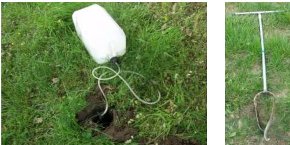
Photographie 3 : Matériel utilisé pour la réalisation des tests d'infiltration de type Porchet
