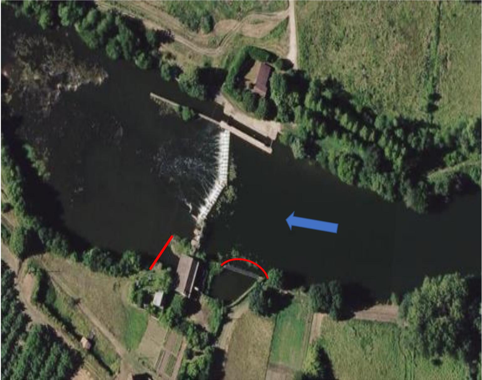
Figure 12: Vue en plan de l'emplacement des batardeaux pour la phase chantier (Source : Géodésie)
