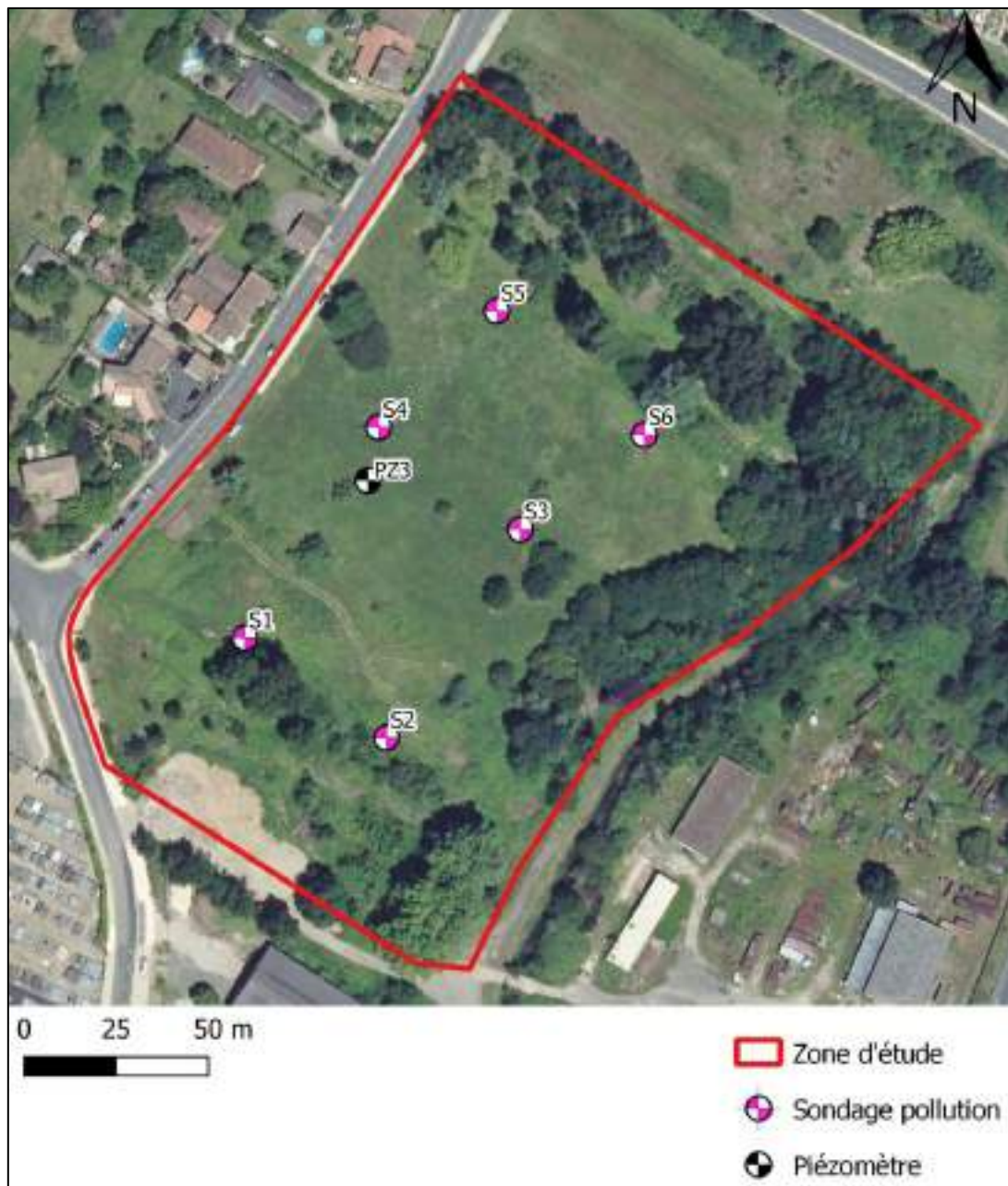
Figure 10 : Implantation des ouvrages
