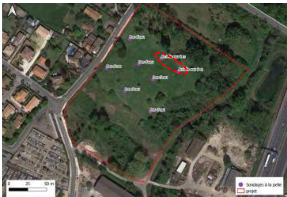
Figure 10 : Localisation des pelles mécaniques réalisées à 3 m de profondeur réalisées en février 2022 (source : ECR Environnement)
