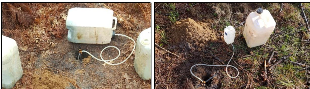
Figure 3 : Tests de perméabilité réalisés au droit du projet
