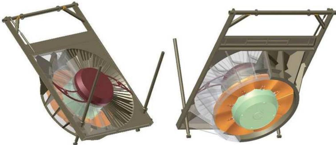
Figure 22 : vue de face et de dos d'une turbine VLH.
