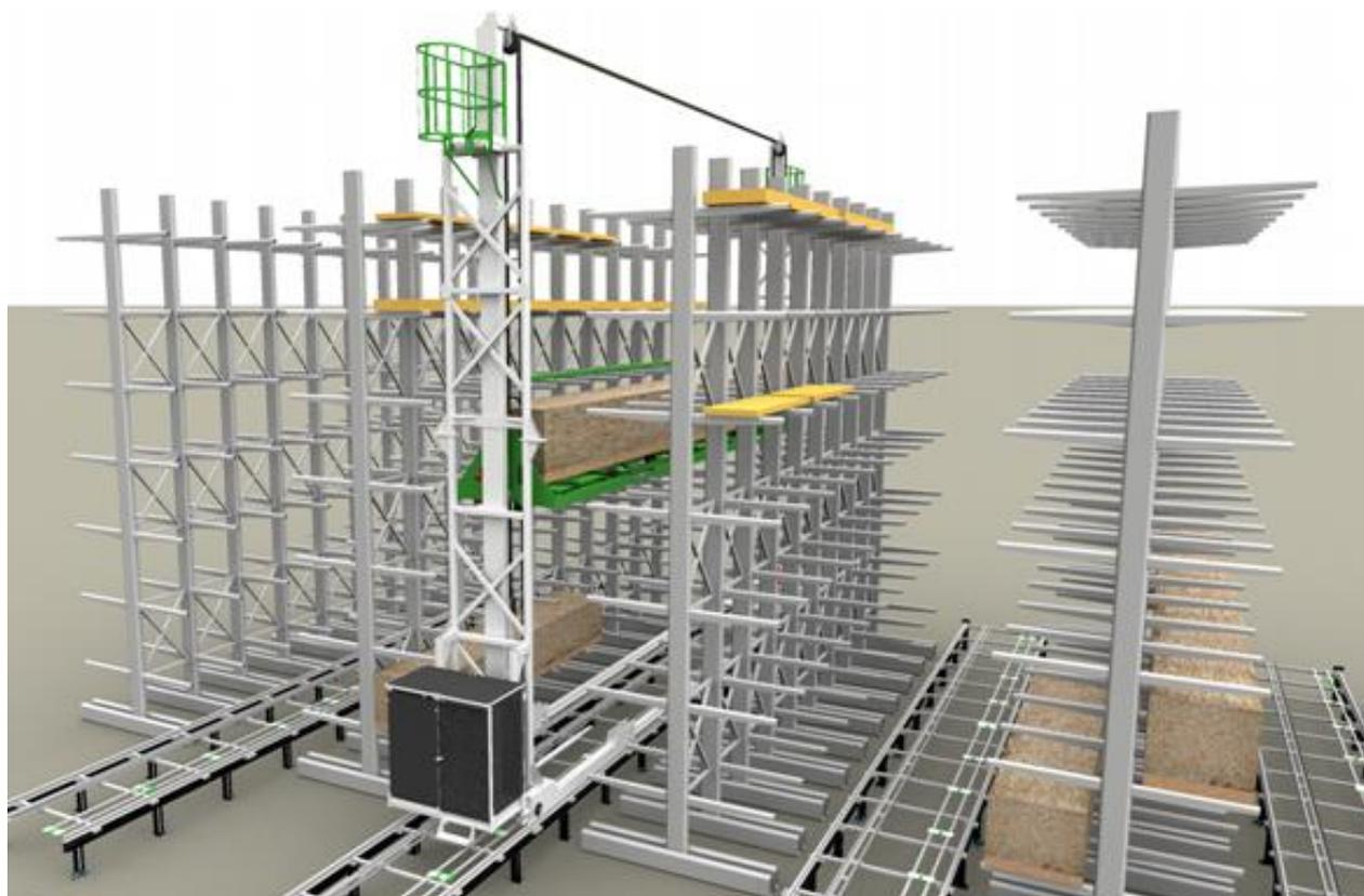
**Figure 4 : Illustration de transstockeurs (source : Chausson Immo)**
