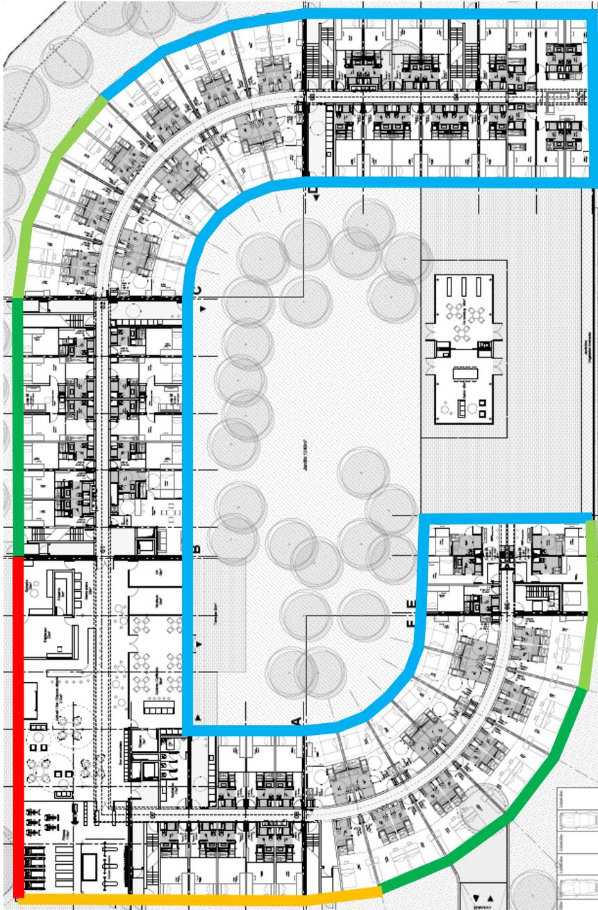
Remarque importante : si une pièce principale ou une cuisine sont situées à l'angle de plusieurs façades requérant des isolements différents, la valeur d'isolement la plus élevée est retenue.
