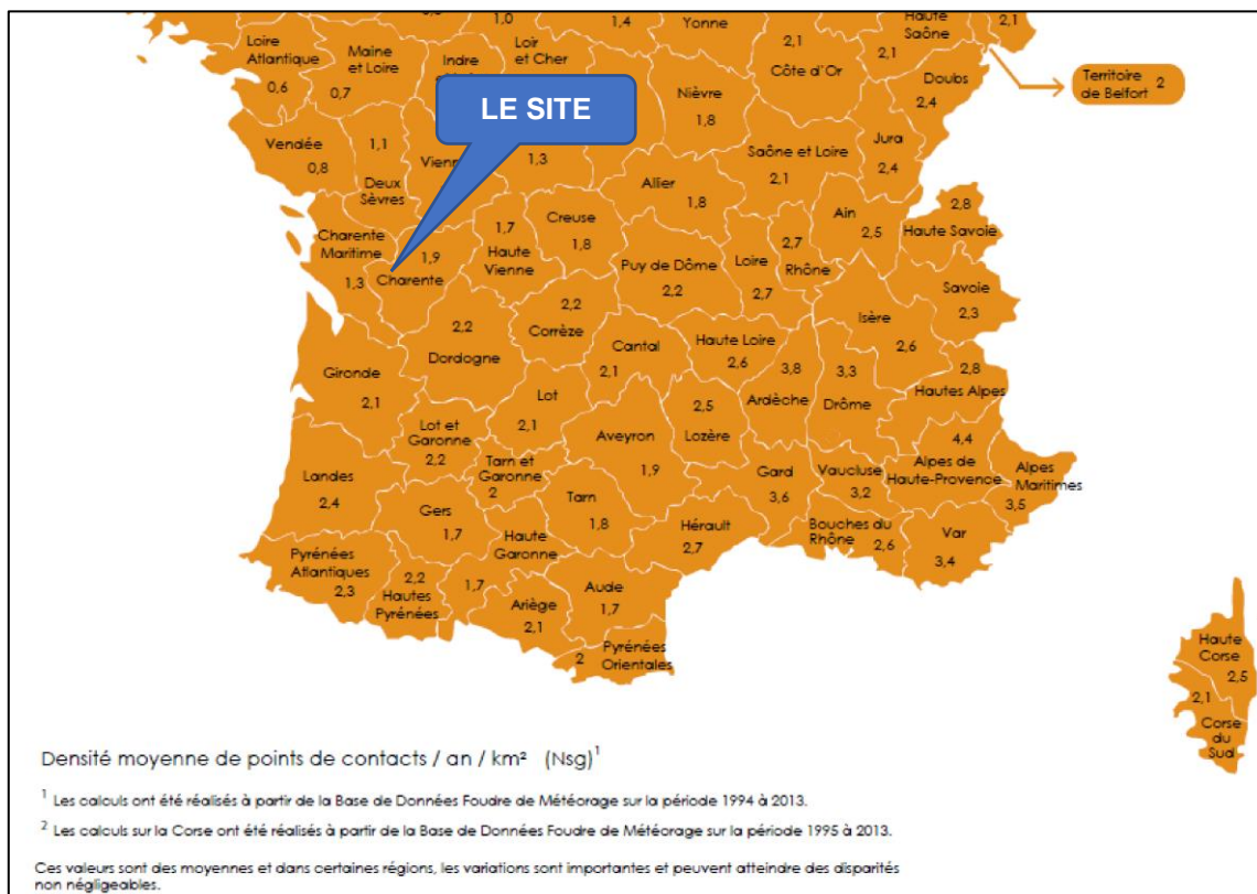
Figure 32 : Carte de la densité de foudroiement de la France issue de la norme NFC 17-102 (05-2015)
