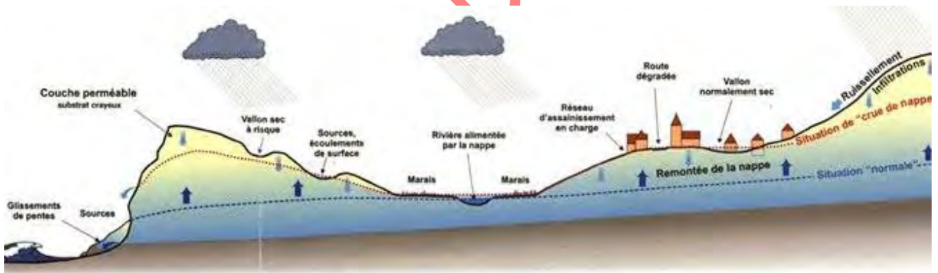
Figure 1 : Coupe de principe de fonctionnement des nappes superficielles (B.R.G.M.)
