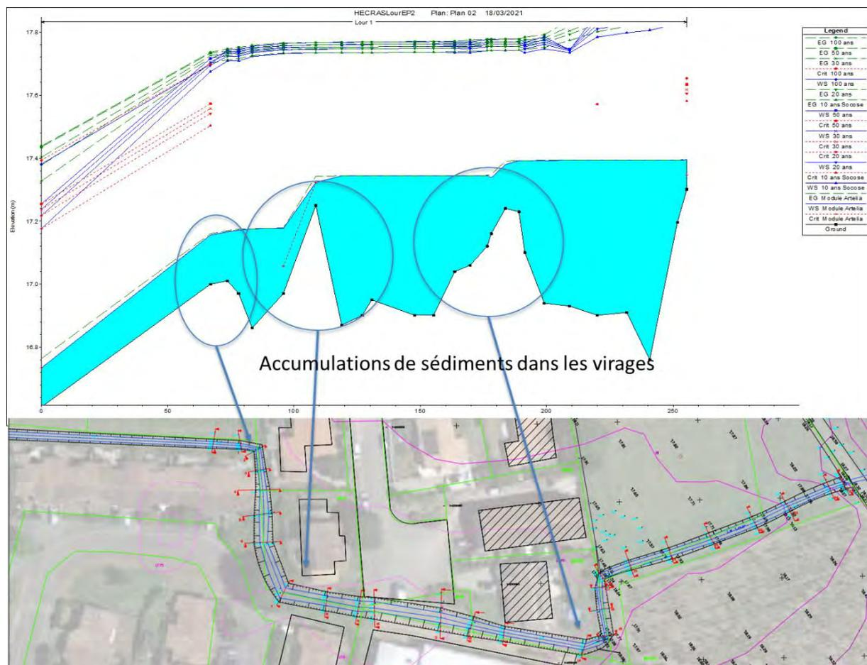
Figure 12 : Modélisation hydraulique du Lour existant
