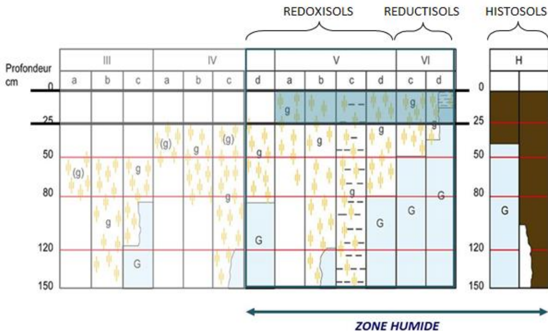
Figure 12 : Schématisation des sols indicateurs de zones humides (Source : GEPPA, modifié NCA environnement)
