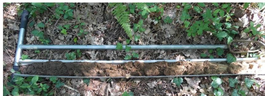
SO2 – solum sableux de texture et structure homogène sur 120 cm - arénolesol
