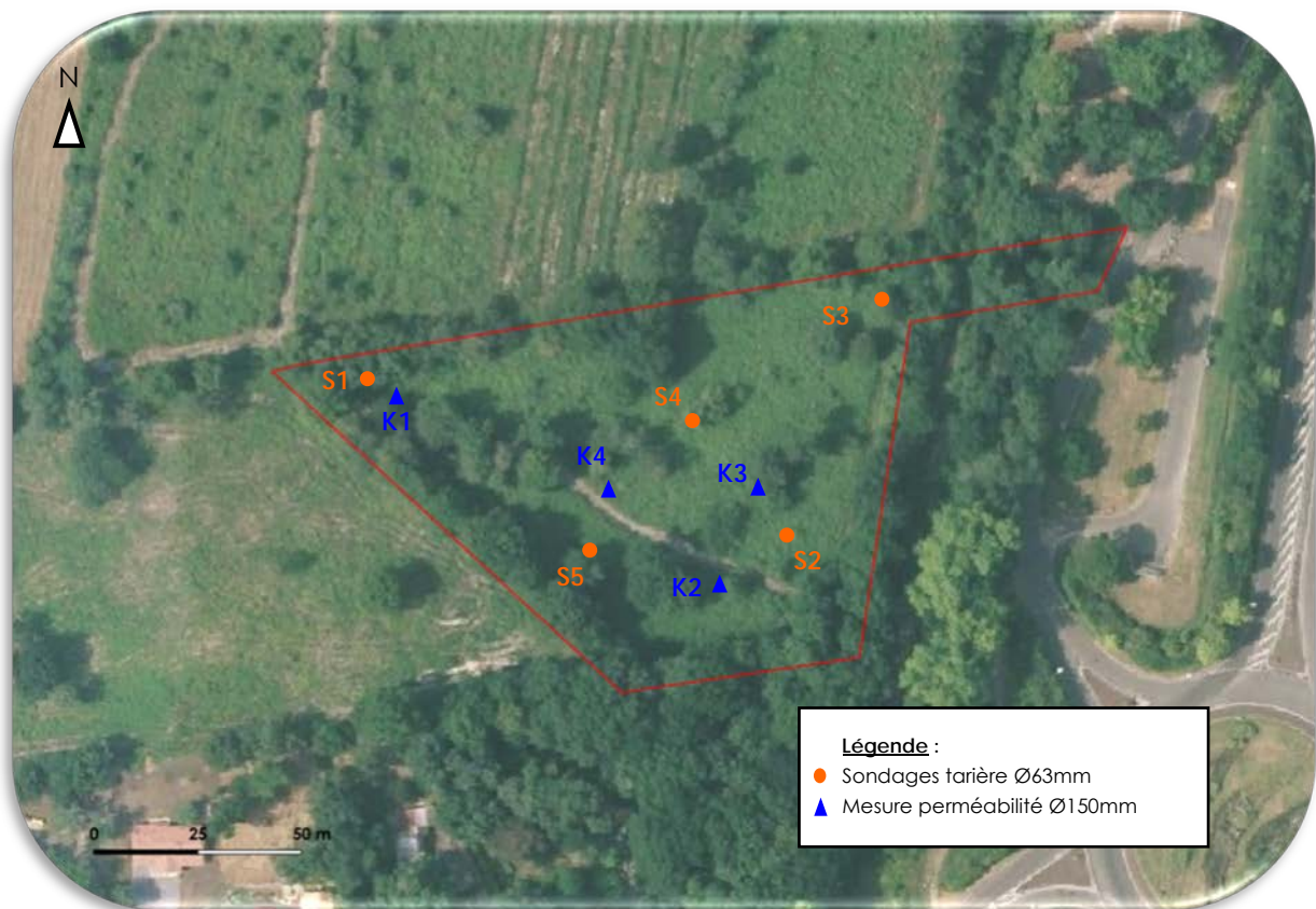
Figure 1 : Implantation des sondages de sol et tests de perméabilité
