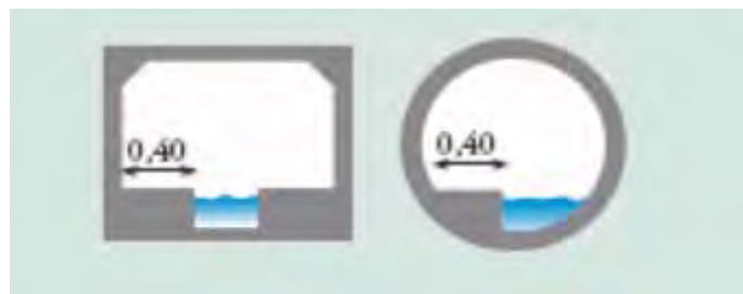
Figure 10 : Passage mixte hydraulique à banquettes submersibles (Source : Fédération des Parc Naturels Régionaux de France)
