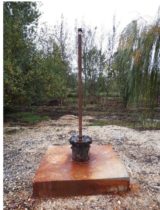
Équipement du forage B 3 pour le suivi de l'artésianisme.
