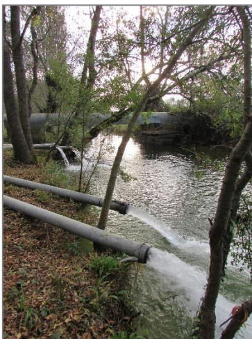
Champ captant de « La Bourgeoisie B4 » : pompage et passage caméra
