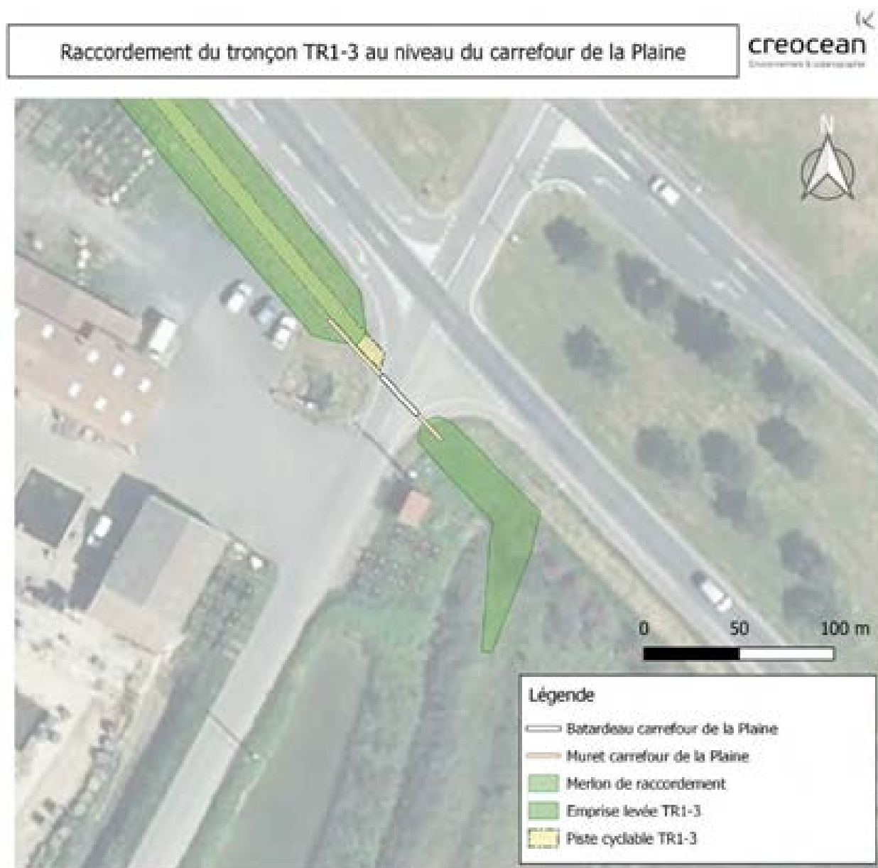
Figure 80 : Vue en plan des aménagements au niveau du carrefour de la Plaine.
