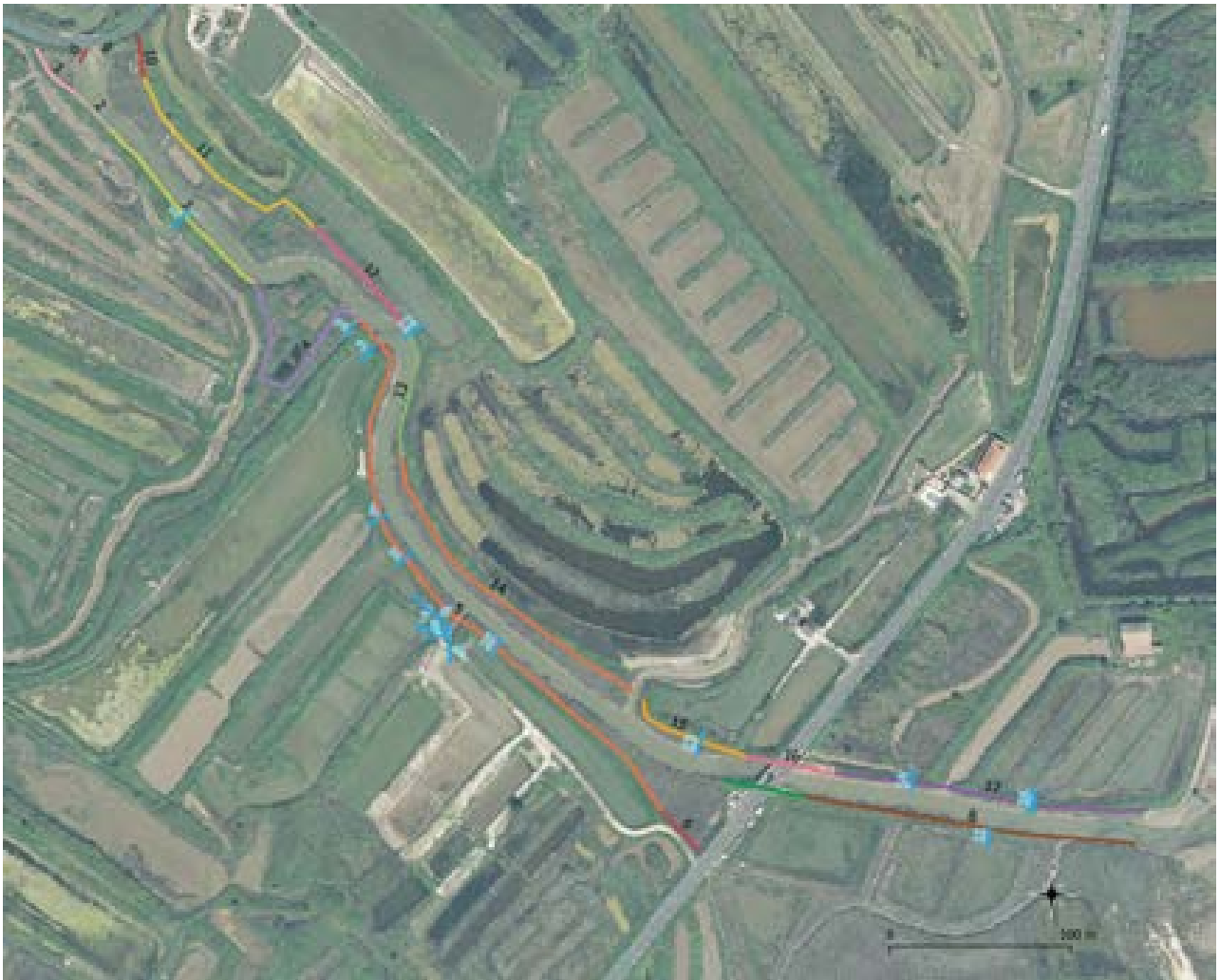
Figure 35 : Cartographie des levées du chenal d'Oulme et des ouvrages hydrauliques traversants (en bleu)
