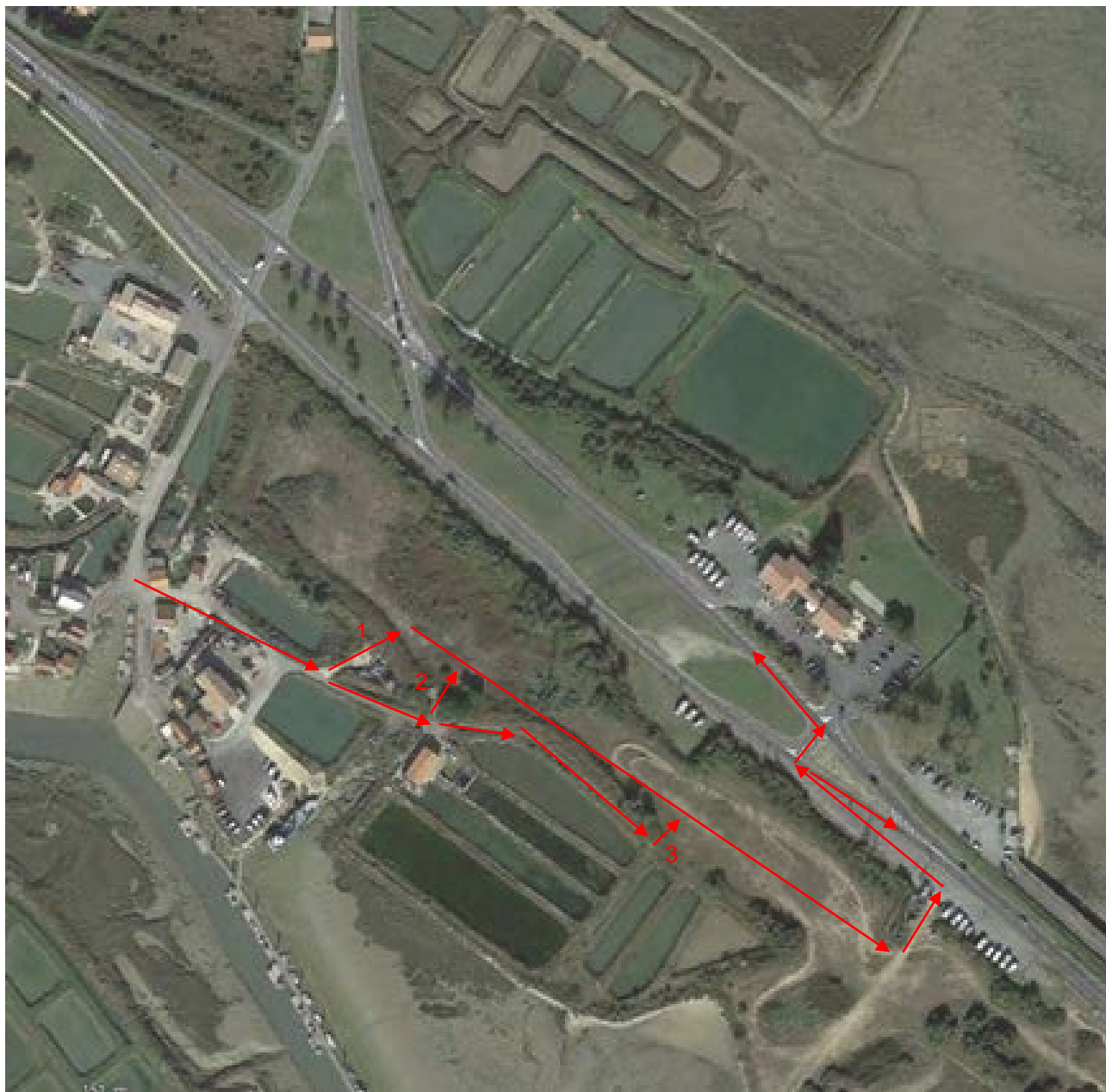
Figure 53 : Cheminement temporaire possible en cas de volonté de maintenir un accès en cas de fermeture du batardeau amovible en travers de la route de la Plaine (Google Earth, 2020)
