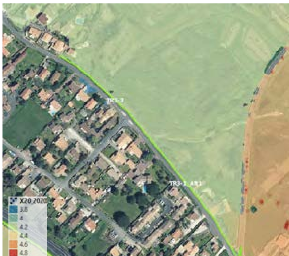
Figure 25 : Résultats de niveaux d'eau pour le scénario 3 (tracé TR3-1 et TR3-2) (Haut) et le scénario 6 (TR3-1_Alt1) (Bas). Nota : les emprises en bleue indiquent que les claires de marais sont déjà remplies à l'initialisation du modèle. Elles n'indiquent pas des zones submergées à l'issue de la submersion.
