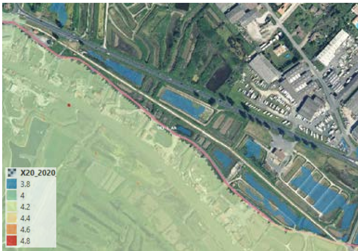
Figure 12 : Résultats de niveaux d'eau (m NGF) pour le scénario 3 (tracé TR1-1) (Haut) et le scénario 4 (tracé TR1-1_Alt) (Bas). Nota : les emprises en bleue indiquent que les claires de marais sont déjà remplies à l'initialisation du modèle. Elles n'indiquent pas des zones submergées à l'issue de la submersion.
