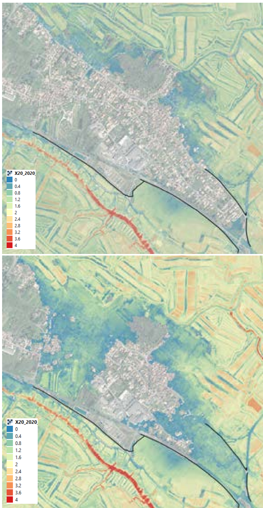
Figure 39 : Cartographie des hauteurs d'eau (en mètres) sans arase (g) et avec arase des digues du Dolmen (d).
