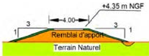
Figure 6 : Coupe-type d'un des aménagements proposés pour les tronçons TR1-1, TR1-2 et TR1-3 (UNIMA, 2017).
