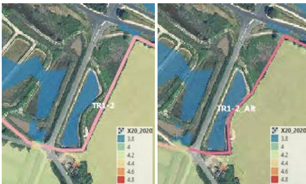
Figure 14 : Résultats de niveaux d'eau pour le scénario 3 (tracé TR1-2) (Gauche) et le scénario 4 (tracé TR1-2_Alt) (Droite). Nota : les emprises en bleue indiquent que les claires de marais sont déjà remplies à l'initialisation du modèle. Elles n'indiquent pas des zones submergées à l'issue de la submersion.
