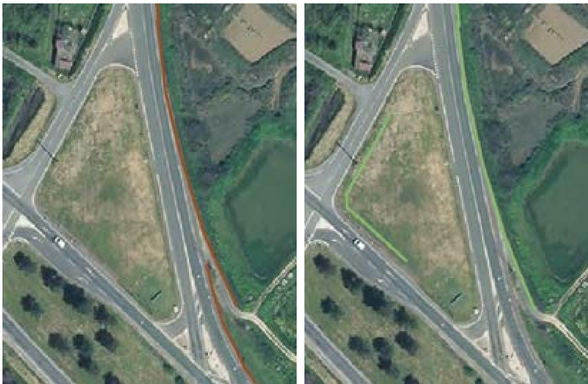
Figure 20 : Tracés supplémentaires étudiés pour empêcher les entrées d'eau depuis le sud du TR2 vers la zone habitée au nord -ouest du carrefour (scénario 7 et 7bis respectivement).
