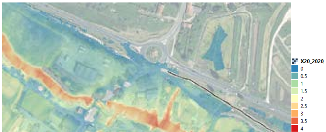
Figure 11 : Cartographie montrant que l'eau ne se propage pas au-delà de la route à l'extrémité ouest du TR1-1.
