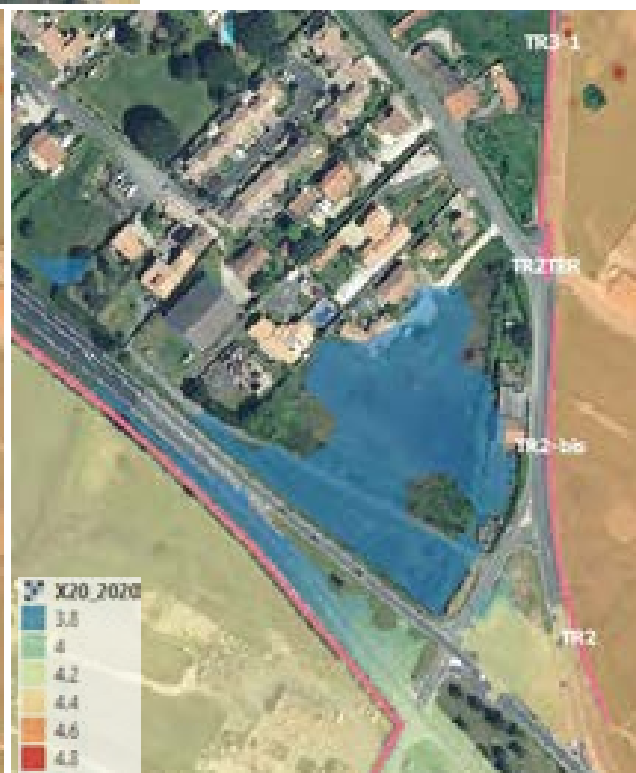
Figure 19 : Résultats de niveaux d'eau pour le scénario 2 (tracé TR2 seul) (Haut Gauche), le scénario 3 (ajout TR2bis) (Bas gauche) et scénario 4 (Ajout TR2ter) (Bas Droite).
