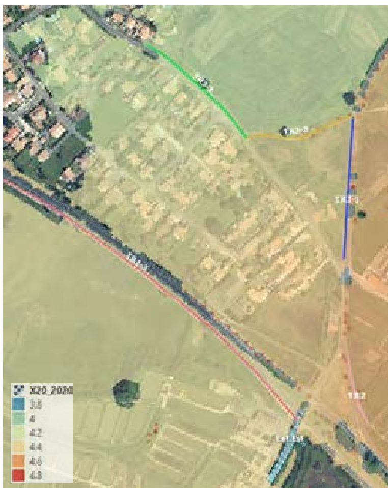
Figure 19 : Résultats de niveaux d'eau pour le scénario 2 (tracé TR2 seul) (Haut Gauche), le scénario 3 (ajout TR2bis) (Bas gauche) et scénario 4 (Ajout TR2ter) (Bas Droite).
