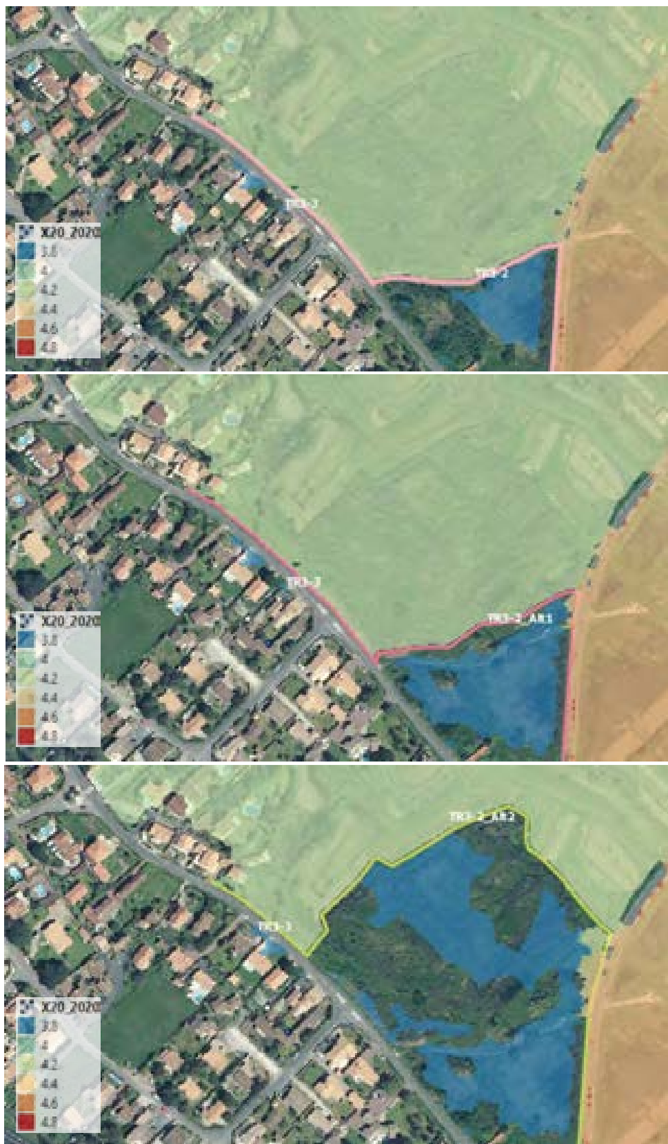
Figure 23 : Résultats de niveaux d'eau pour le scénario 3 (tracé TR3-2) (Haut), le scénario 4 (TR3-2_Alt1) (Centre) et le scénario 5 (TR3-2_Alt2) (Bas).
