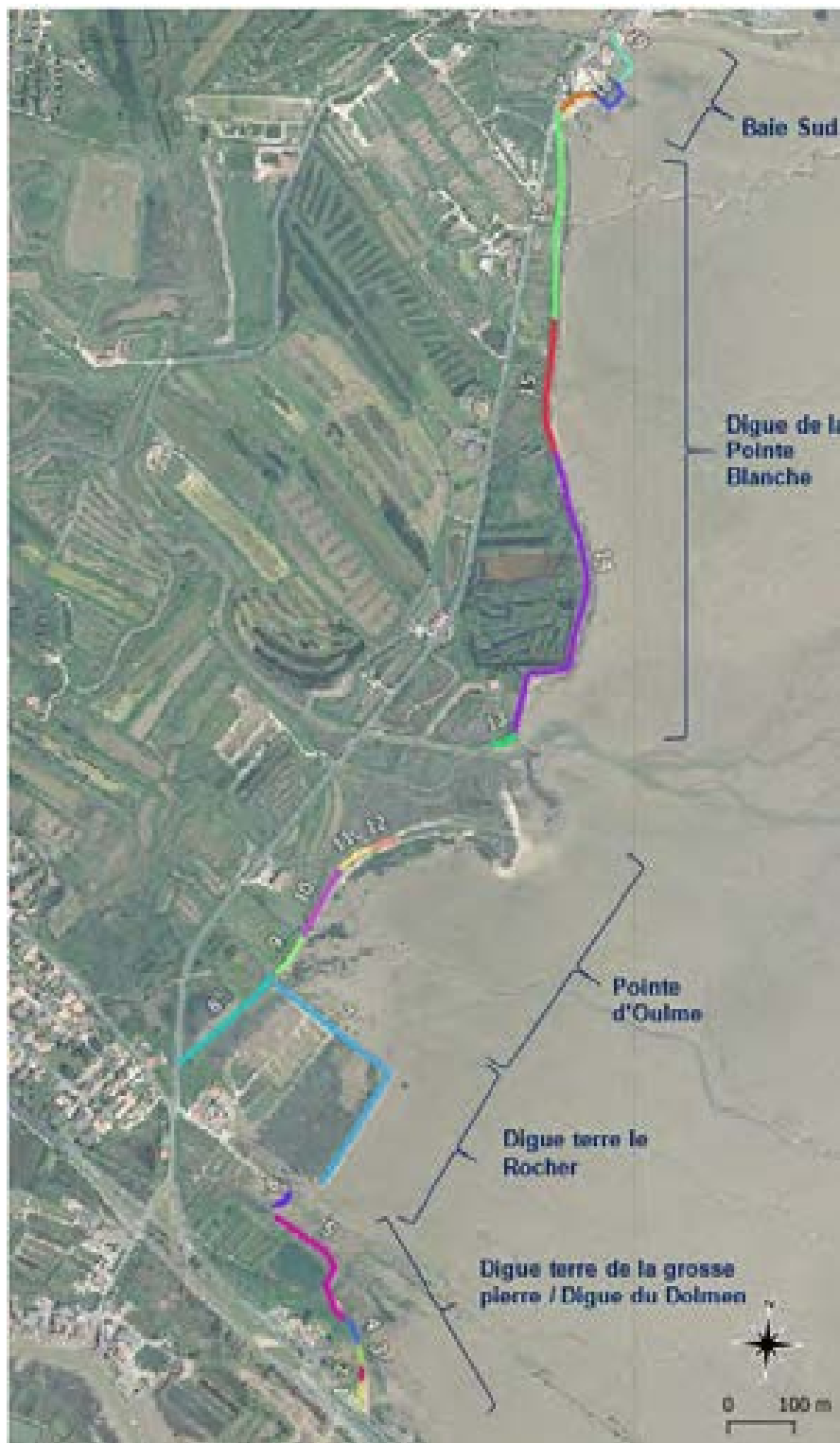
Figure 36 : Cartographie des tronçons d'ouvrages sur les digues de premier rang.
