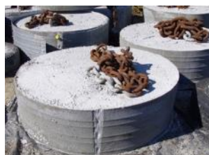
Exemple de corps morts cylindriques en béton avec départ de chaîne mère
