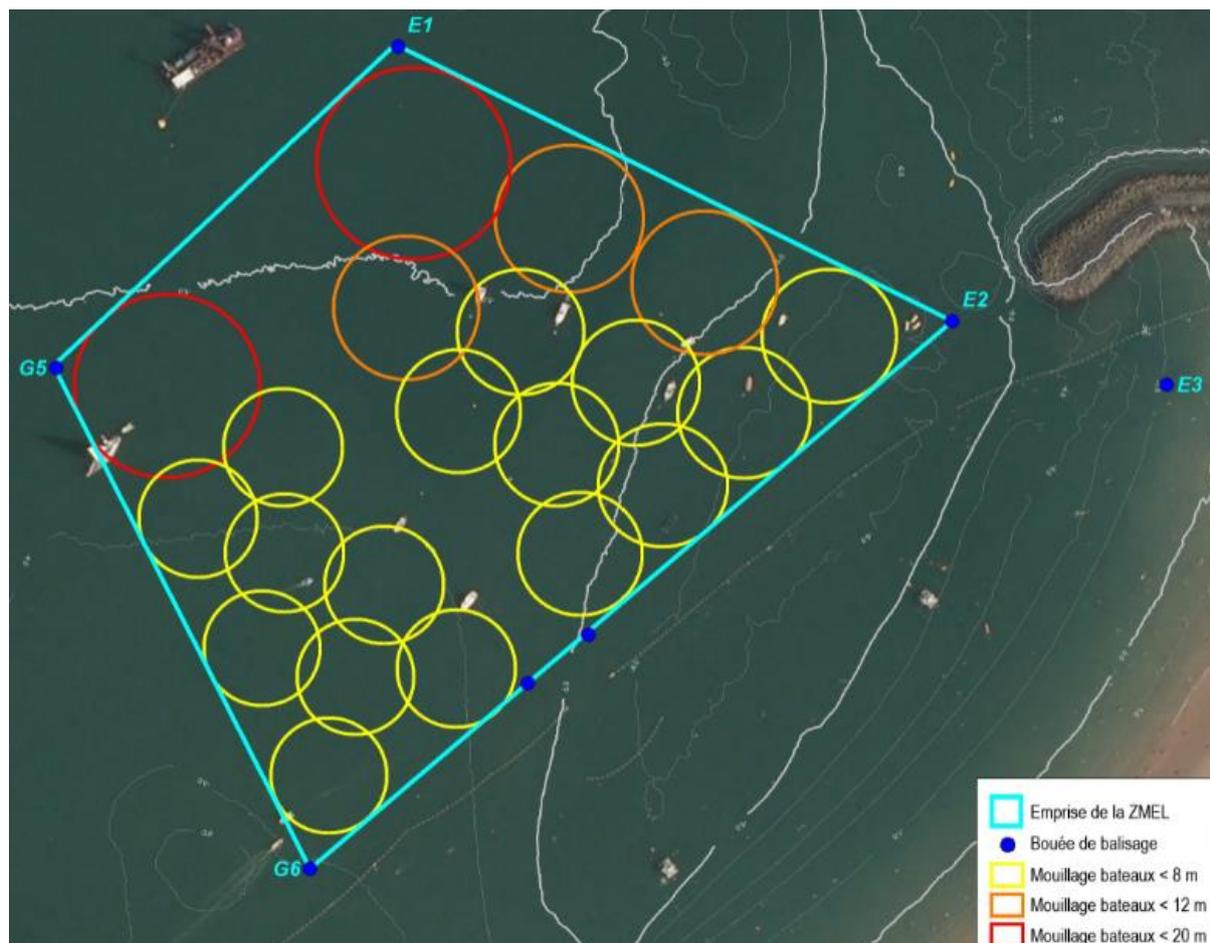
Figure 7 : Plan d'implantation des mouillages dans la zone de mouillage de Saint-Jean-de-Luz
