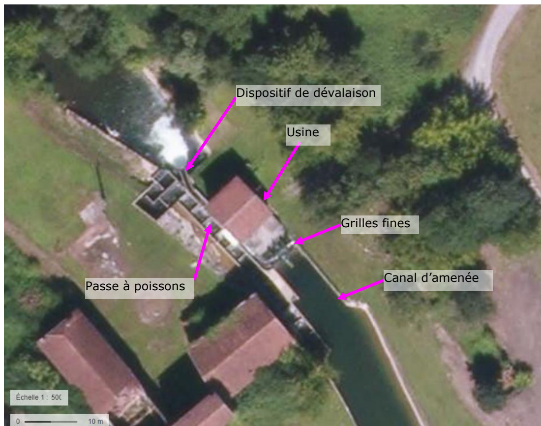
Figure 4: Zoom sur usine existante – 1/500 ème
