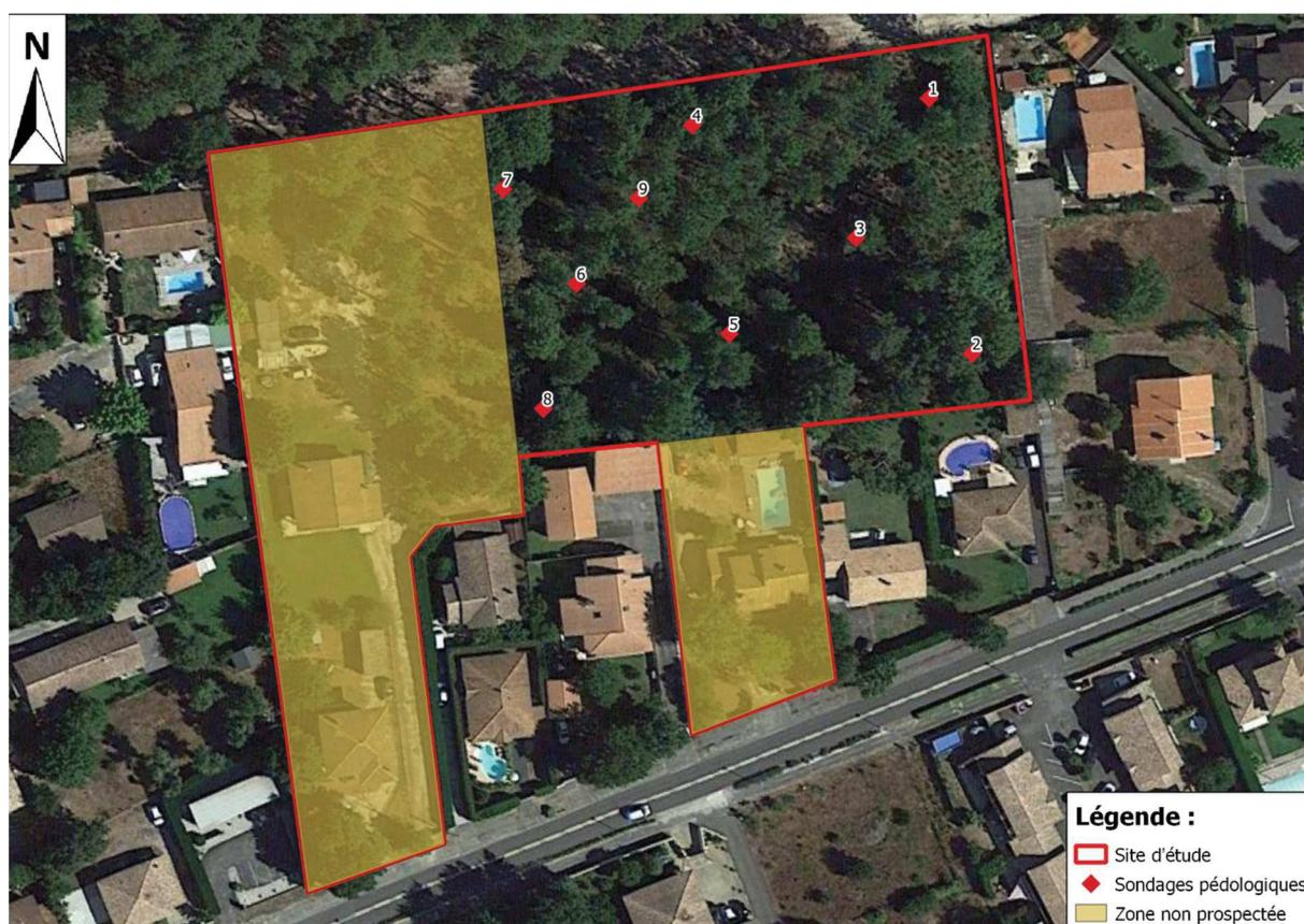
Figure 19: Plan de localisation des sondages
