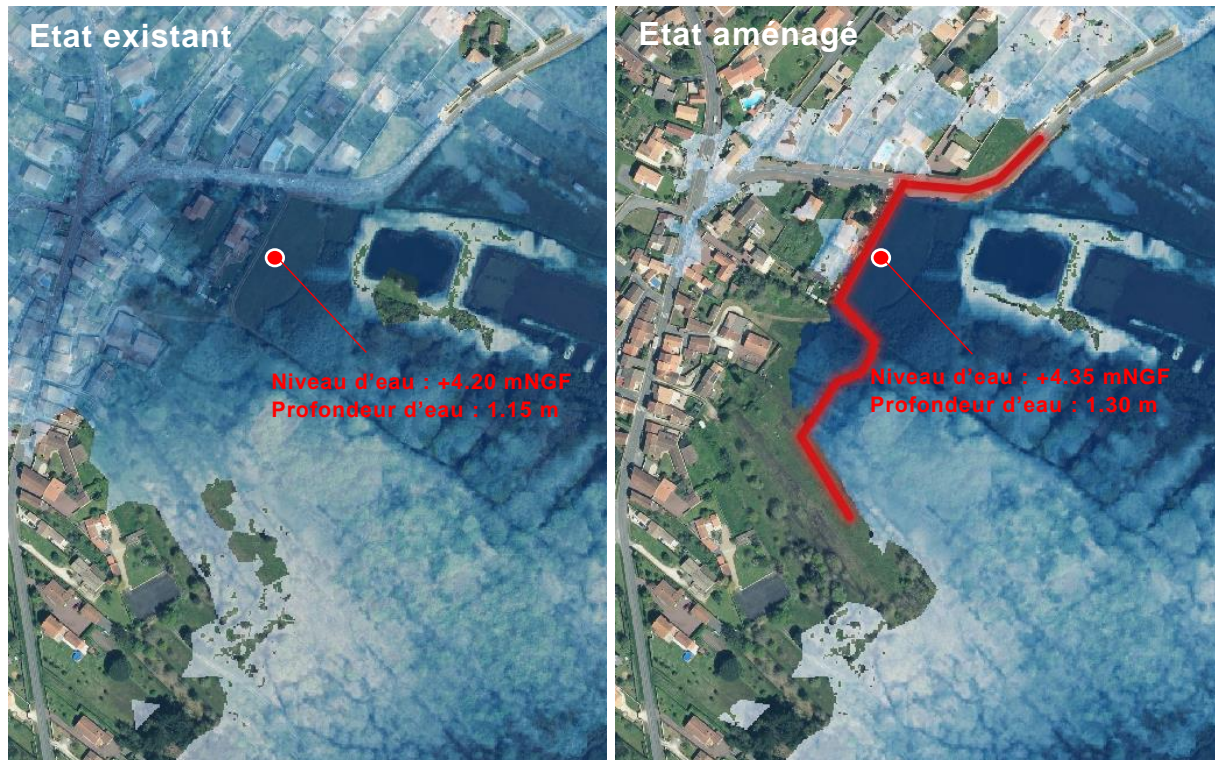
Figure 40 : Comparatif des épaisseurs d'eau entre situation existante et projetée
