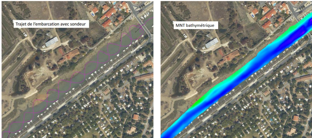
Figure 38 : Exemple du trajet d'acquisition de données et du MNT bathymétrique résultant dans le chenal de la Perrotine.
