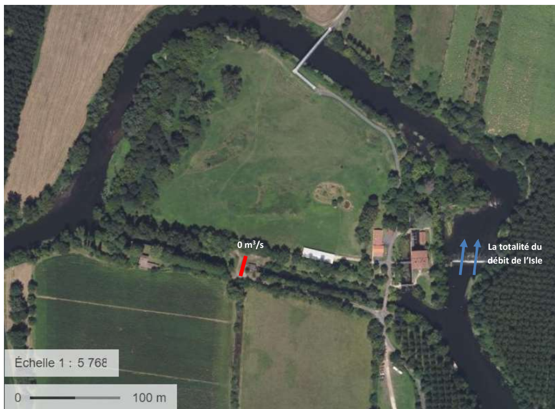
FIGURE 11: REPARTITION FUTURE DES DEBITS DE L'ISLE
