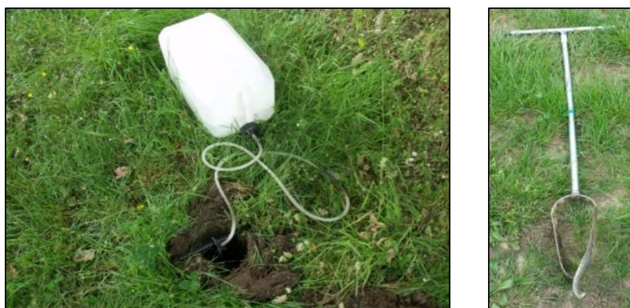
Photographie 1 : Matériel utilisé pour la réalisation des tests d'infiltration de type Porchet
