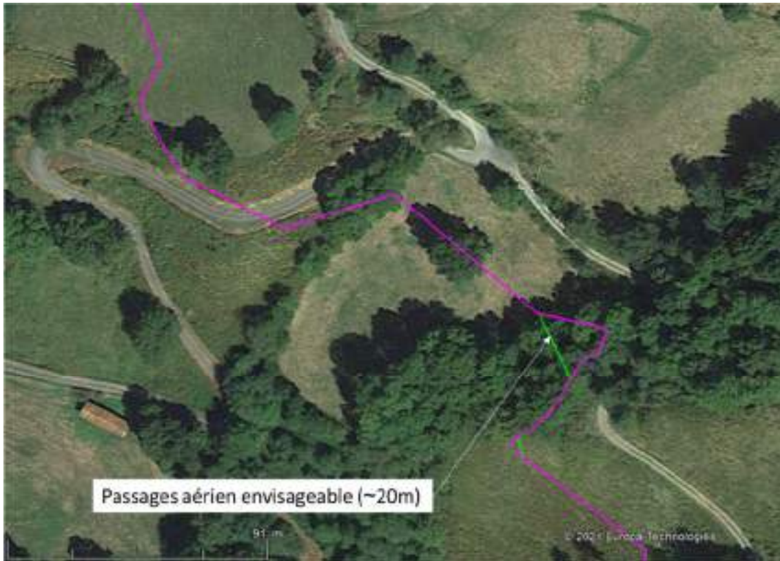
Figure 4 : Solution de passage aérien envisagé pour le vallon en amont de la traversée de la route.
