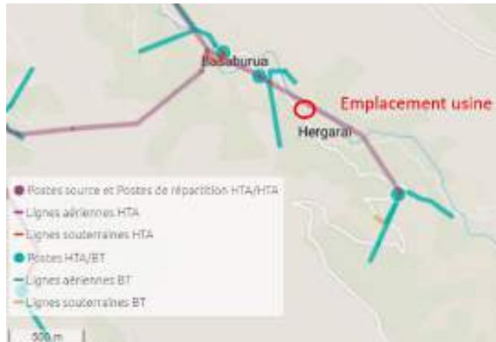
Figure 31 – Lignes aériennes 20 kV (source Enedis – cartographie des réseaux)
