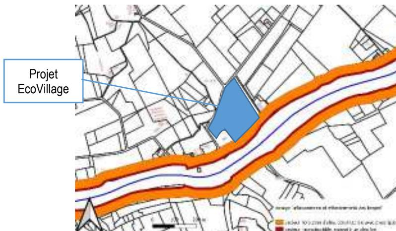
Figure 5 : Extrait du plan de zonage du PPRn – risque d'instabilité des berges : emprise de la zone inondable
