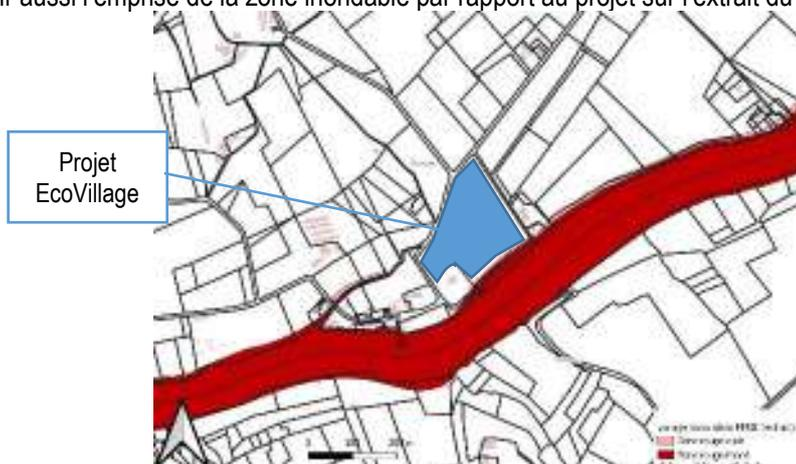
Figure 4 : Extrait du plan de zonage du PPRn – risque inondation : emprise de la zone inondable
