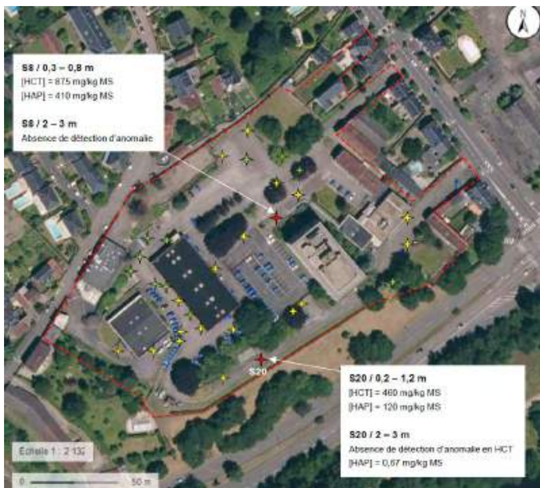
Figure 36 : Localisation des anomalies détectées (Source : Rapport d'investigations des sols –VERITAS EXPLOITATION)
