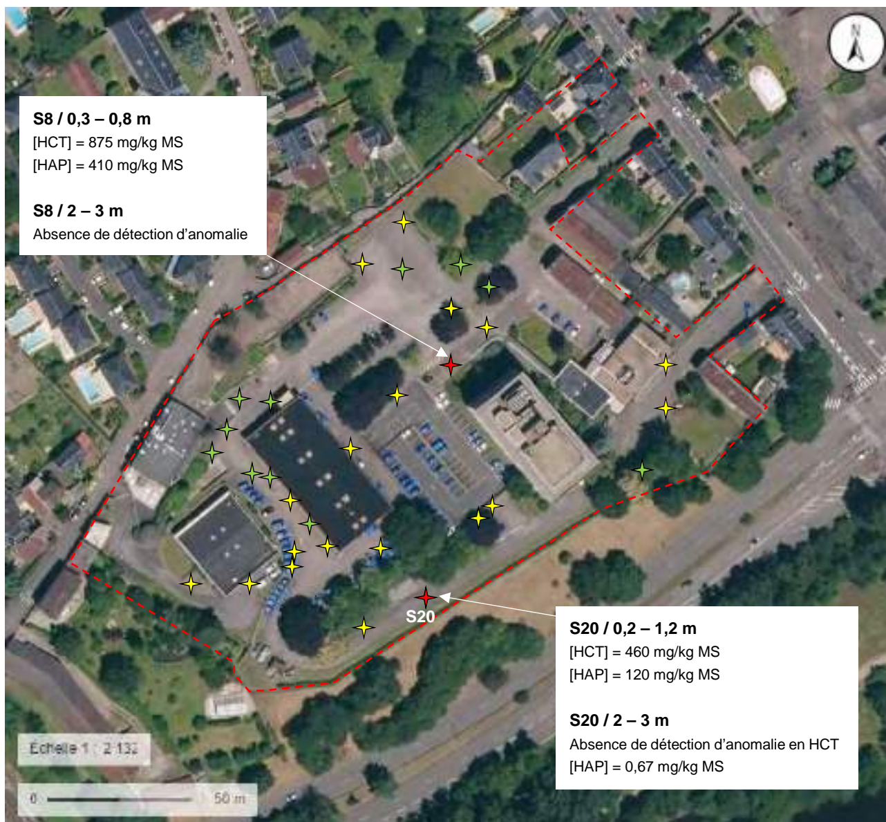
Figure 6 : localisation des anomalies détectées
