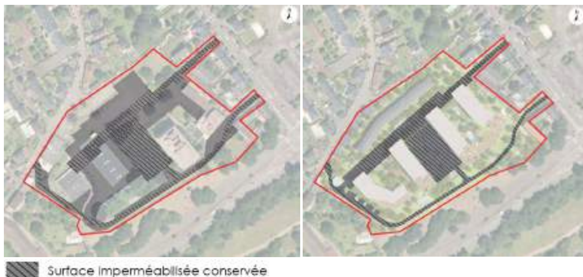
Figure 50 : Surface imperméabilisée avant-projet (à gauche) et après-projet (à droite) (Source : Carnet de présentation – ADVENTO)
