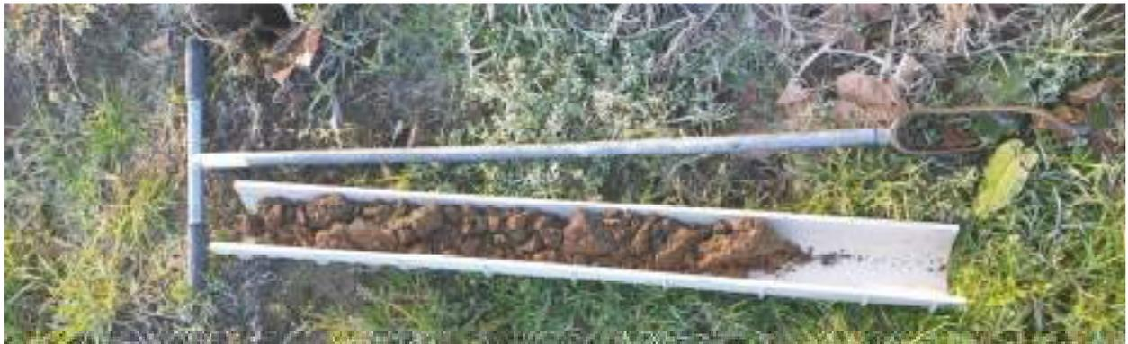
Figure 22 : Illustration d'un essai à la tarière réalisé sur le site d'étude
