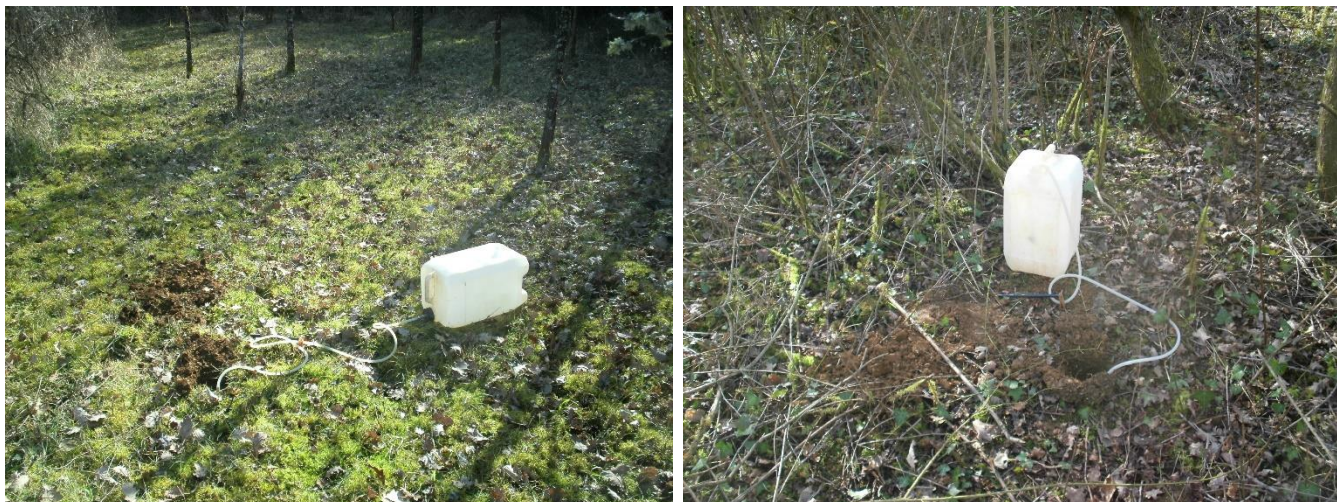
Figure 5 : Photos test de Porchet-phase de saturation
