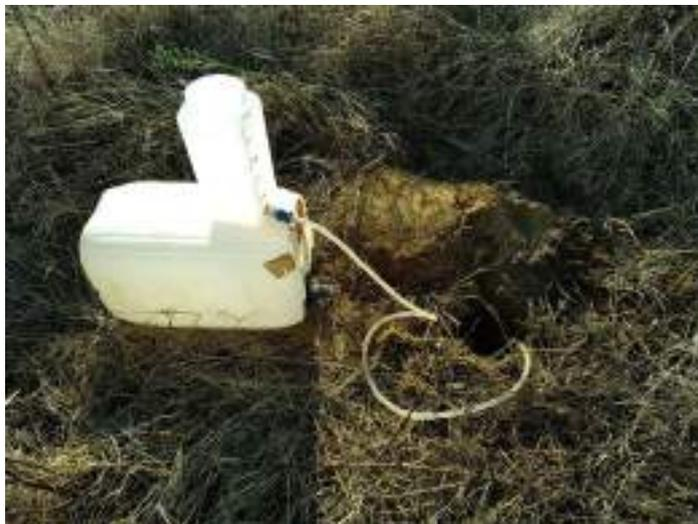
**Figure 9 : Photographie de l'essai de perméabilité E1**
