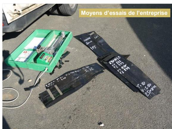
**Tensiomètre destiné aux réglages des machines à souder**
