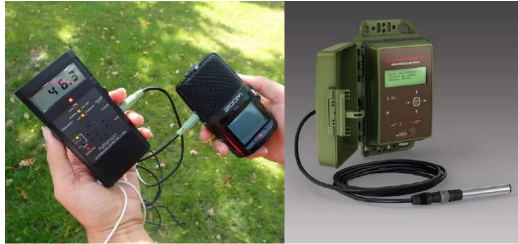
Figure 48 : Matériel d'écoute utilisé : Gauche D240X relié à un enregistreur ZOOM, à droite SM4BAT
