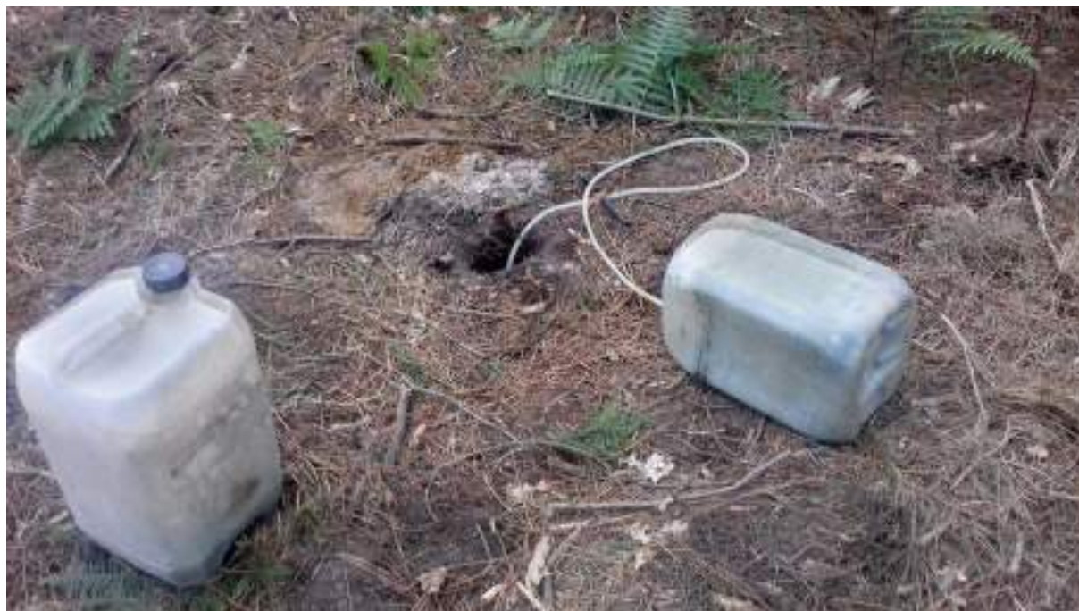
Figure 2 : Test de perméabilité réalisé (T1) au droit du projet
