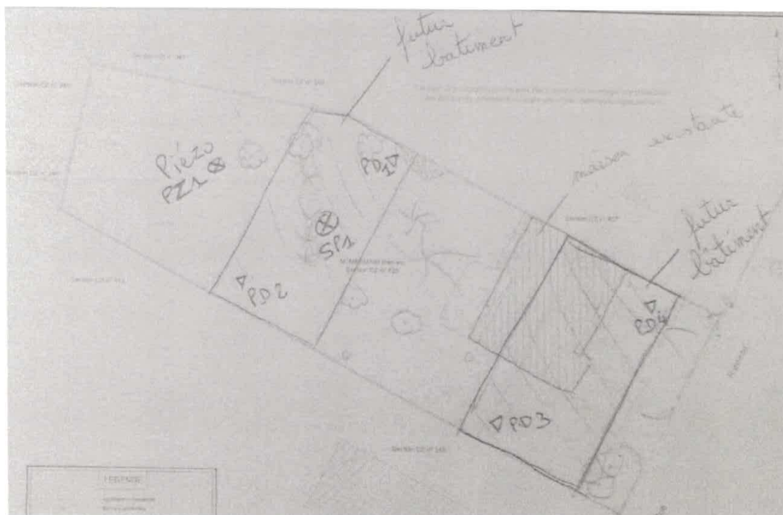
Figure 1 : Localisation des sondages de sol (source : Terrefort, 2021)
