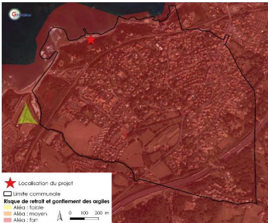
Figure 13 : Risque de retrait et gonflement des argiles sur la commune de Guéthary (Sources : Google satellite, Géorisques ; Cartographie : GEOCIAM)
