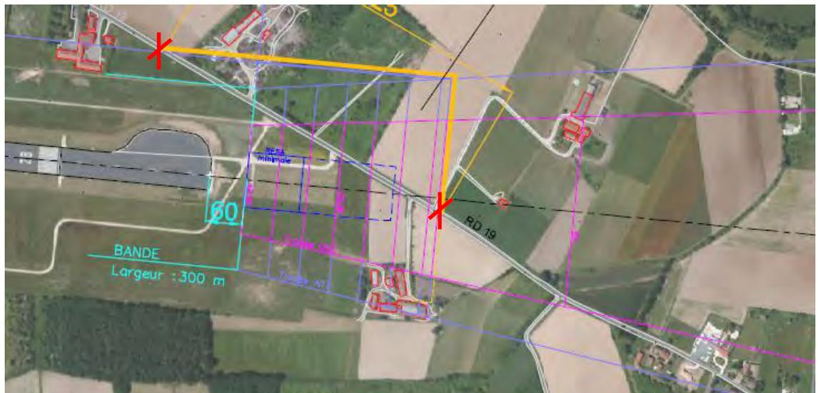
Le dévoiement de la RD19 est rendu obligatoire, afin de se mettre en conformité avec les servitudes aéronautiques visant à créer une aire de sécurité d'extrémité de piste d'une longueur suffisante.
