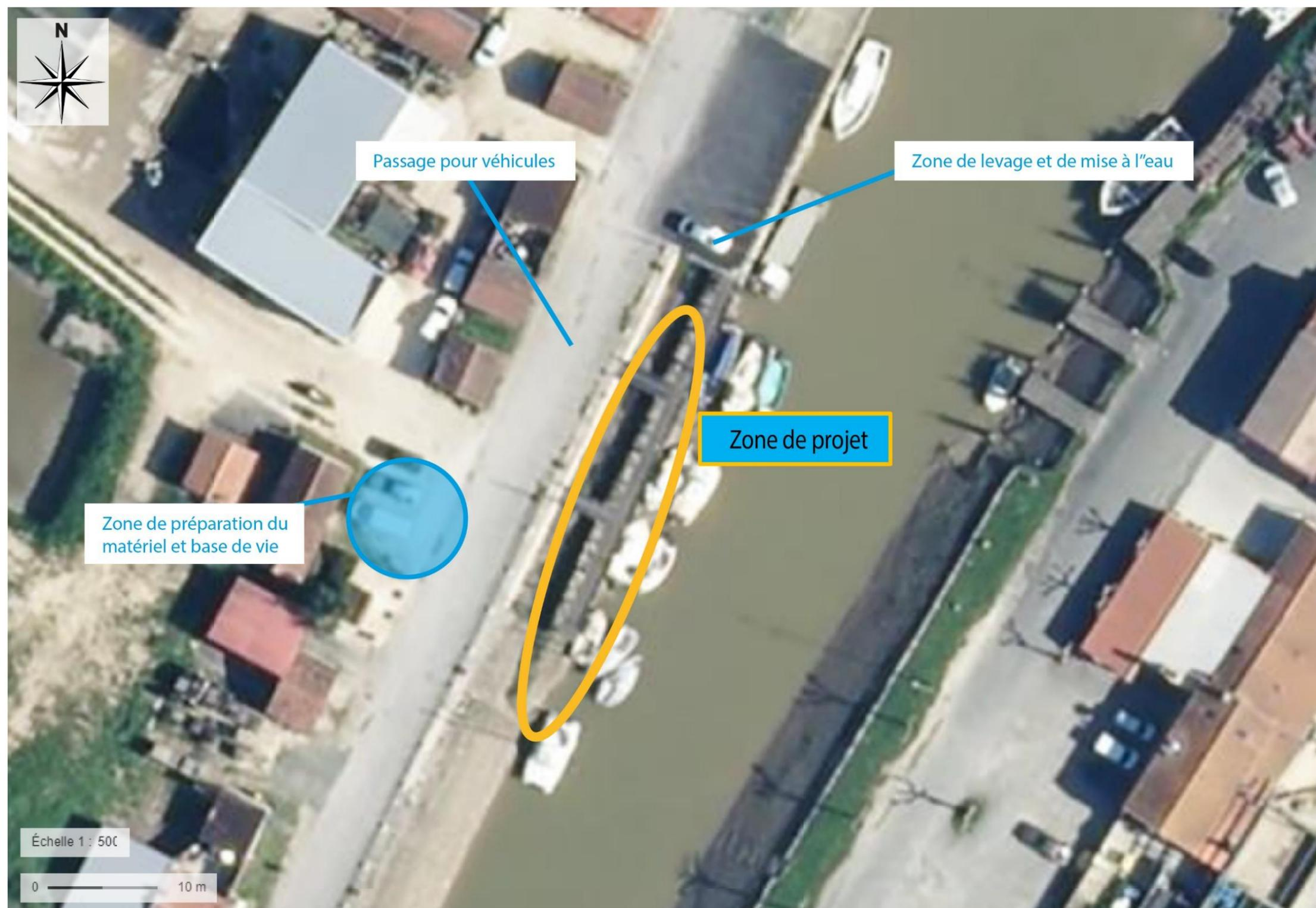
Figure 9 : Plan des installations de chantier sur le port (Source : Géoportail)
