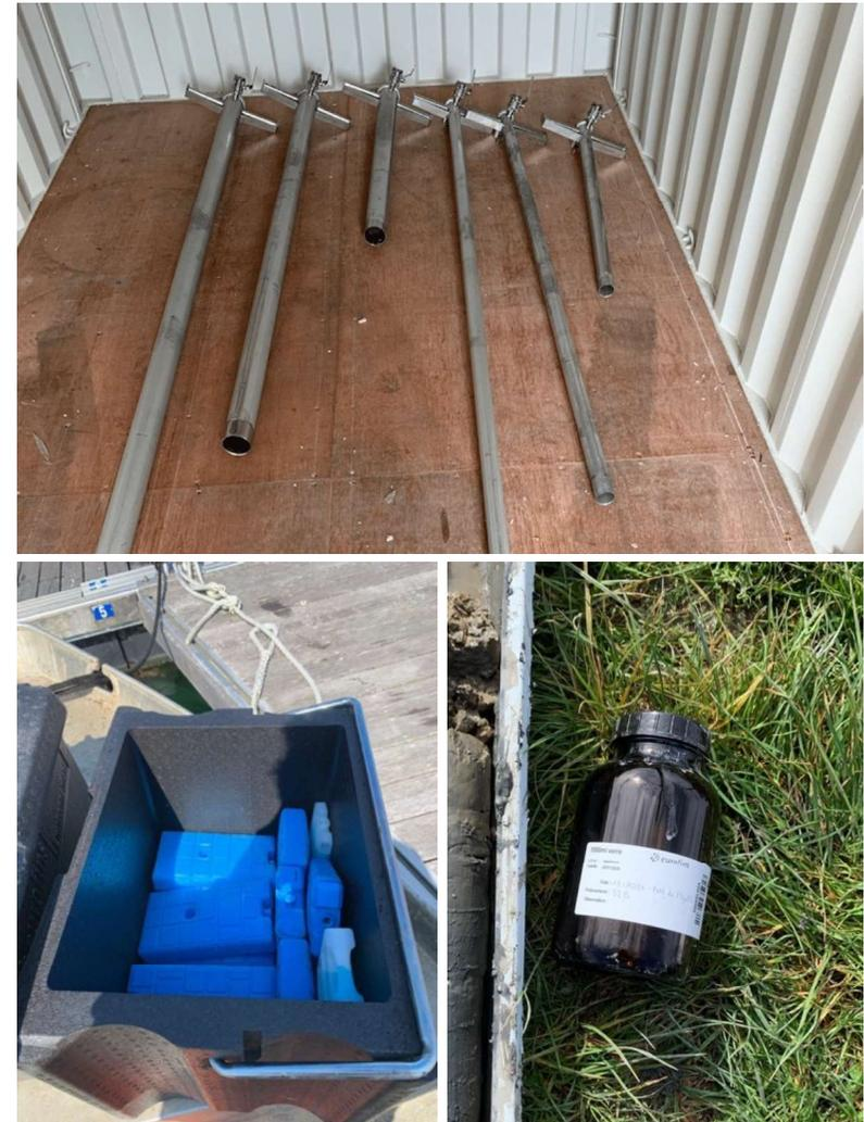
Figure 3 : Carottiers de 1 à 3 m en haut, glacière avec pains de glace et flacon d'échantillonnage en bas
