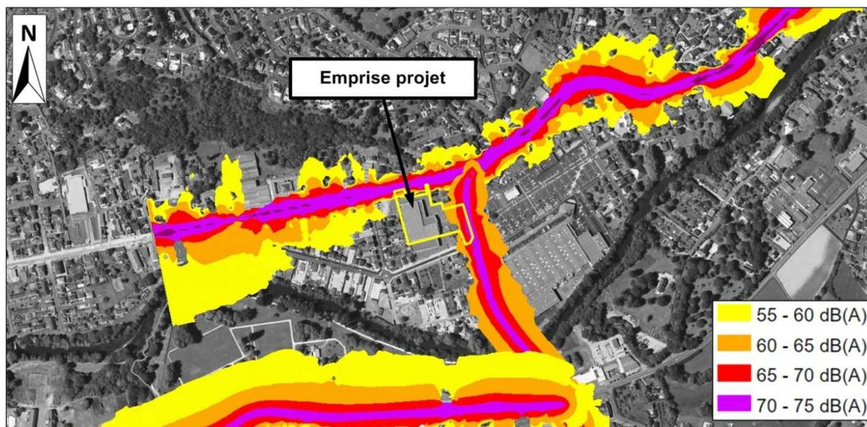
Figure 19 : Zones exposées au bruit par des infrastructures routières et ferroviaires situées à proximité du projet
